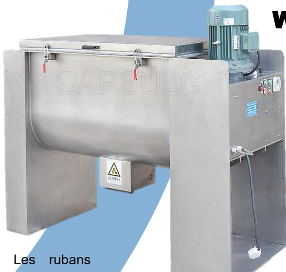
Les mélangeurs à ruban se composent d'une auge horizontale en forme de U, de pièces de transmission et de lames d'agitation de ruban qui ont généralement des couches doubles ou triples avec une vis extérieure rassemblant le matériau des côtés au centre et une vis intérieure transmettant le matériau du centre vers les côtés pour former un mélange de convection et un agitateur à ruban spécialement fabriqué.
