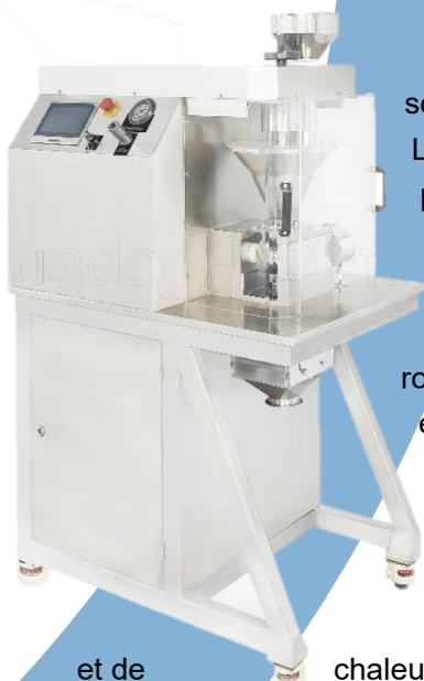
Les granulateurs à sec sont utilisés pour le processus de granulation à sec. Le procédé de granulation à sec est utilisé pour former des granulés sans utiliser de solution liquide car le produit à granuler peut être sensible à l'humidité et à la chaleur. La formation de granulés sans humidité nécessite de compacter et de densifier les poudres. Dans ce processus, les particules de poudre primaires sont agrégées sous haute pression.
