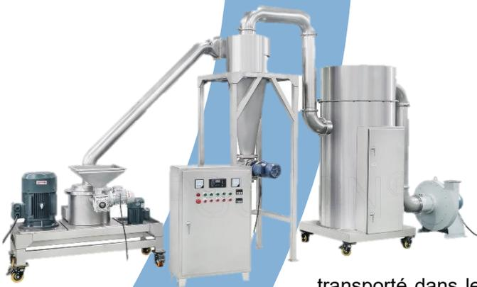
La série de broyeurs superfins WFJ est un équipement qui permet d'obtenir un broyage ultrafin de matériaux secs par séparation d'air, broyage à haute pression et cisaillement.
