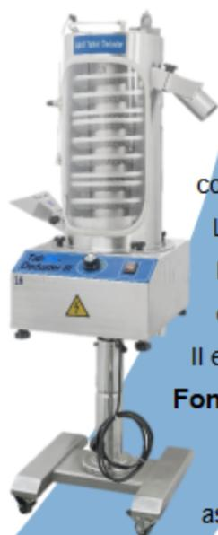
Le dépoussiéreur de tablette Tab CN -Deduster III Pro Uphill est un équipement spécial pour éliminer les bavures et la poussière de tablette tout en montant. Il peut être connecté à une presse à comprimés et à des systèmes de détection de métaux.
