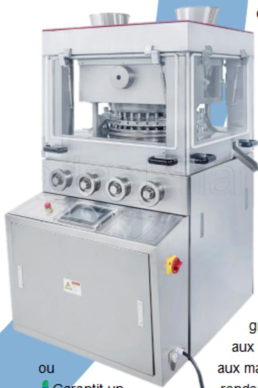
Cette machine est une sorte de machine rotative automatique pour le pressage continu de comprimés. Il est principalement utilisé pour la production de comprimés dans l'industrie pharmaceutique. Il convient également à d'autres industries telles que la chimie, l'alimentation et l'électronique pour presser le matériau granulaire en comprimés.
