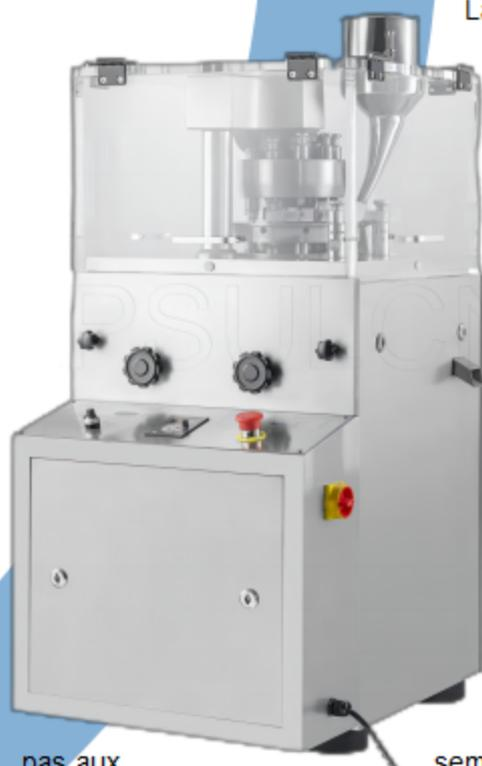
La presse à comprimés rotative électrique TabCN-9 pro est une petite machine à presser les comprimés avec rotation automatique et pressage continu des comprimés. Dans la plage de pression de la machine, elle peut presser les matières premières granulaires avec une teneur en poudre inférieure à 10 % en comprimés ronds, de forme spéciale et de lettrage de 5 à 20 mm. Il est principalement utilisé dans les industries pharmaceutique, chimique, alimentaire, électronique et autres.
