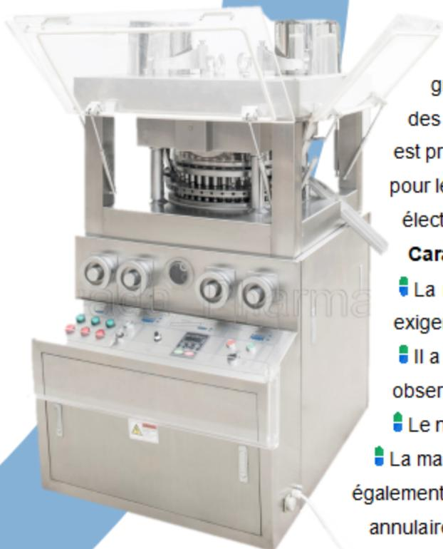
La machine est une machine à presser les pièces à rotation automatique à double pressage qui pourrait faire en sorte que le grain soit pressé pour être une pièce ronde, des caractères sculptés, des formes spéciales et une prescription de pièces à double couleur. Elle est principalement utilisée dans la fabrication de prescriptions de pièces pour les entreprises de l'industrie pharmaceutique industrie, alimentation, électronique.
