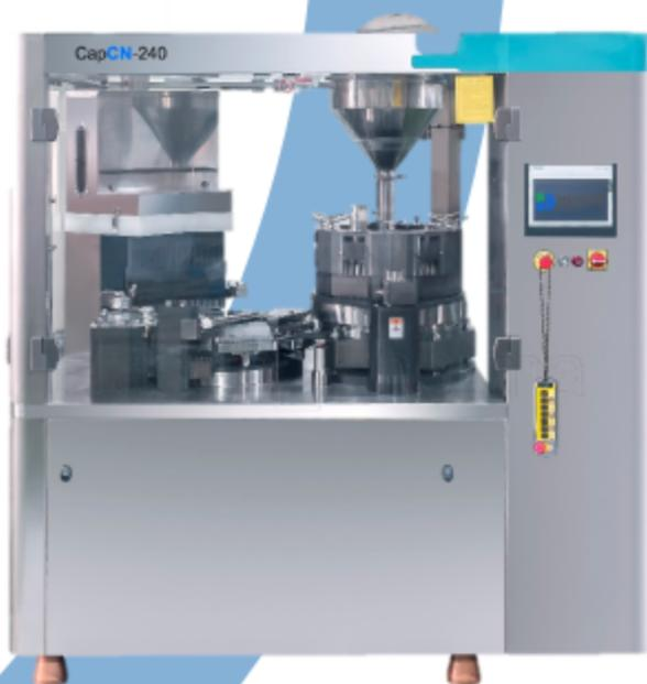
CapCN -72/240 traite les produits pour une productivité optimale jusqu'à 1200/4000 capsules par minute, avec un fonctionnement nécessitant peu d'entretien, des temps d'arrêt minimaux et une production globalement fiable.
